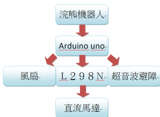
圖一、浣熊機器人架構圖
