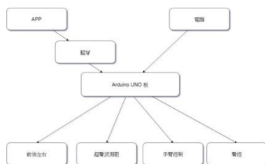
圖一 Arduino 手臂搬運車製作流程圖
