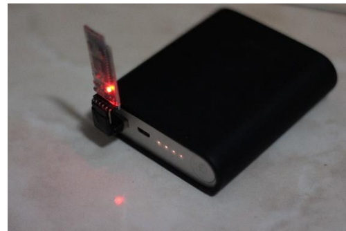
圖 2：使用行動電源的 iBeacon 發訊器
