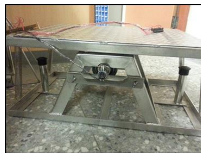
圖 3：角度計安裝示意圖
